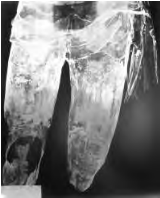
33. Radiografies en les quals s'observa el buit intern de l'escultura, els claus, les llacunes en les policromies, a més de les grans masses d'estuc de guix i blanc de plom que els rajos X no poden penetrar.
