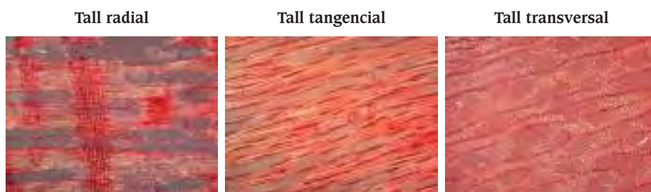
30. Visió dels tres talls de la fusta al microscopi òptic.
