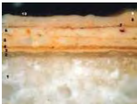
15. Imatge obtinguda al microscopi òptic de la secció transversal de la mostra núm. 2 (objectiu MPlan 20 X / 0,40). L'ordre numèric dels estrats és el que apareix en la taula de descripció annexa.
